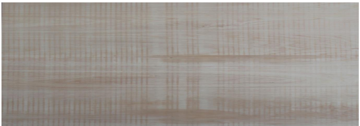
Die quer verlaufenden Streifen stammen aus der Produktion und sind ein typisches Oberflächenmerkmal
